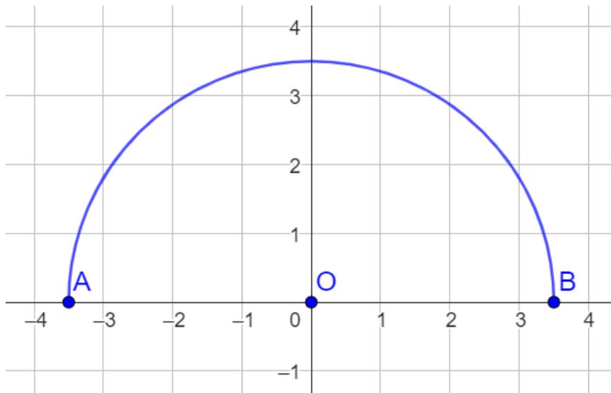
Le contour considéré est symétrique par rapport à l'axe des ordonnées donc l'abscisse de  $G$  est  $x_G = 0$ . Pour calculer  $y_G$  on utilise la fonction  $\gamma : t \mapsto (t, \sqrt{R^2 - t^2})$  et puisque la longueur du contour est  $\pi R$  on sait que :
