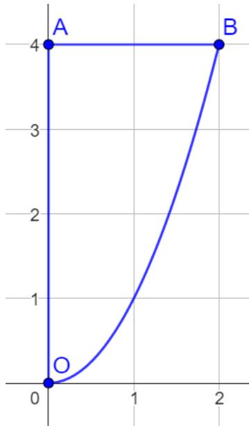
Le centre du segment  $[OA]$  est son milieu c'est à dire le point de coordonnées  $(0, 2)$  et le centre du segment  $[AB]$  est de même le point de coordonnées  $(1, 4)$ . Il reste à calculer le centre  $F$  de la courbe reliant  $O$  et  $B$  et pour cela on peut approcher cette courbe par une suite infinie de segments :
