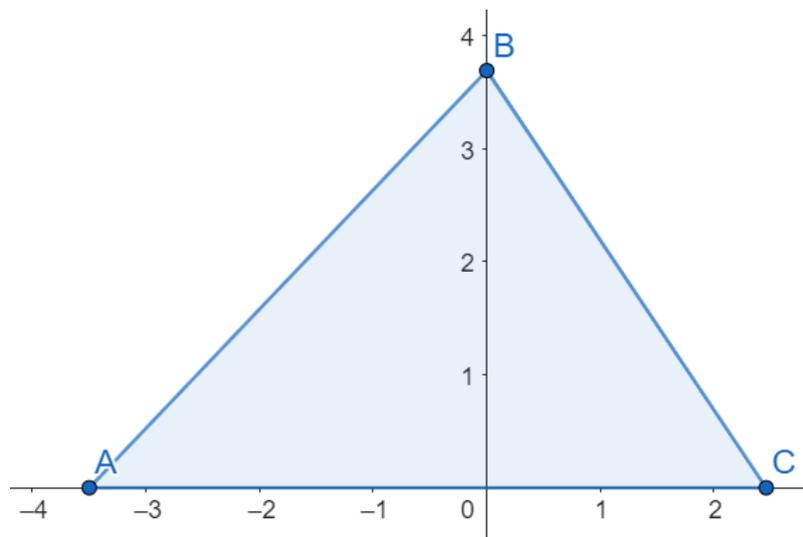
Un triangle quelconque peut toujours être divisé en deux triangles rectangles. Si on note  $O$  le point de coordonnées  $(0, 0)$  alors le centre de la surface triangulaire  $AOB$  a pour coordonnées  $(-a/3, b/3)$  et le centre de la surface triangulaire  $BOC$  a pour coordonnées  $(c/3, b/3)$  d'après l'exemple précédent. Pour trouver le centre  $(x_G, y_G)$  de la surface triangulaire  $ABC$  on calcule la moyenne de ces deux points pondérée par les aires des triangles ce qui nous donne :
